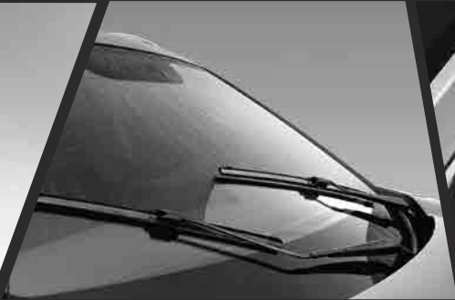
Auto Wiper with Rain Sensor Wiper akan menyala secara otomatis saat hujan turun
